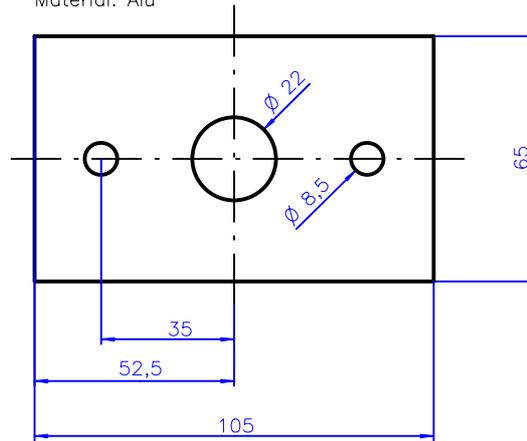
Platte zwischen Dichtung / Flansch:
